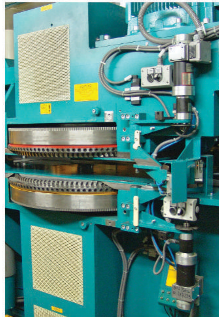
Hohe Genauigkeit bei horizontaler Bearbeitung wird mit einem sehr kurzen Abstand zwischen den beiden Rotoren erreicht.
