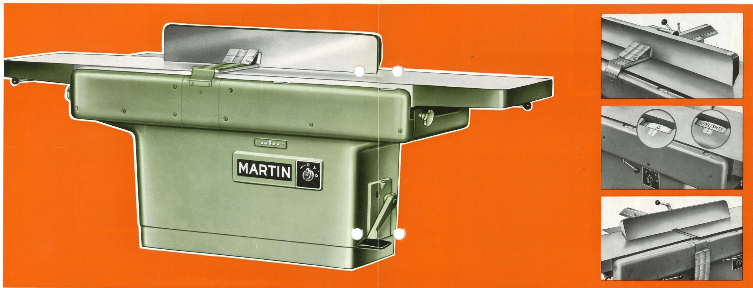
Jeder der beiden Tische ist durch einen Hebel geklemmt. Wenn man die Tische zum Messereinsetzen oder Kehlen auseinanderziehen will, braucht man nur diese beiden Hebel zu lösen. Auch dadurch ergeben sich sehr kurze Umstellzeiten.
