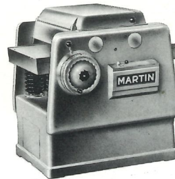
T 41 Dickenhobel- maschine Hobelbreite 630 mm
