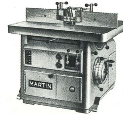
T 23 Schwenkräse Spindel von -5 bis +46° schrägstellbar 3000 + 4500 + 6000 + 9000 UpM
