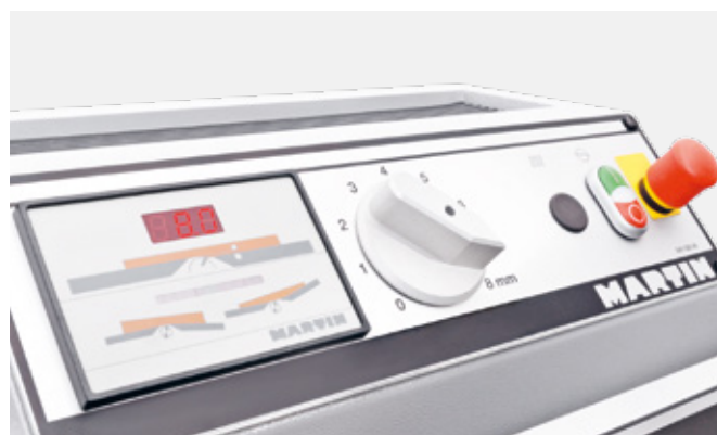
Pulpit obsługi kombinowany i przemieszczający się razem z ogranicznikiem wyrównywania | T544
