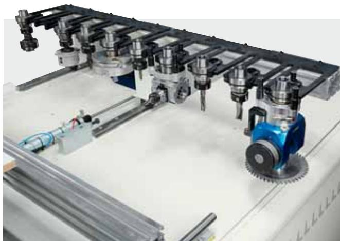
Máquina equipada en todo momento para trabajar gracias a la gran capacidad para herramientas que garantizan la tool room de 16 posiciones, situada en la parte posterior, y el bastidor de 10 posiciones, situado en el lado derecho de la máquina.
