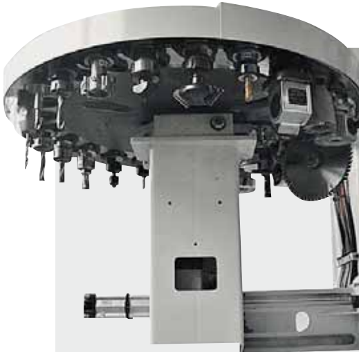
TR10 E RAPID 16 O 24 Máquina equipada en todo momento para trabajar gracias a la gran capacidad para herramientas (hasta 34 posiciones).
