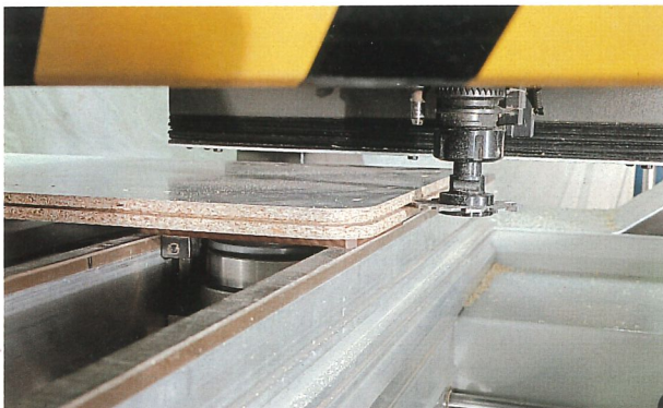
▲ Vorbereiten der Nut für PVC-Umleimer
