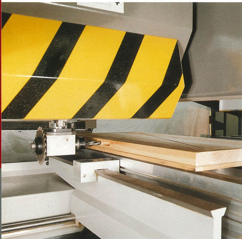
360° Horizontal- winckelgetriebe mit Aufnahme für Nutsäge und Schafffräser.
