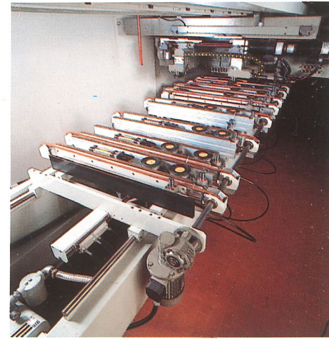
Arbeitstisch mit automatischem Mehrfachförderer.
