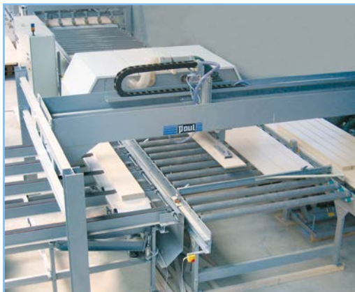
Fig. 35 Empilage des bandes avec un empileur à dépression, type portique à la sortie d'une scie multilames K34G/2200 à alimentation automatique
