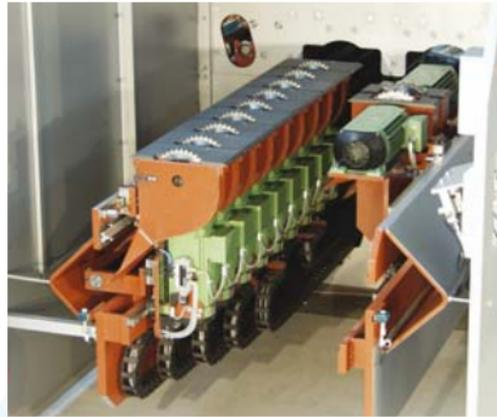
Einzeln positionierbare Sägesupporte der Modellreihe K34VARIO
