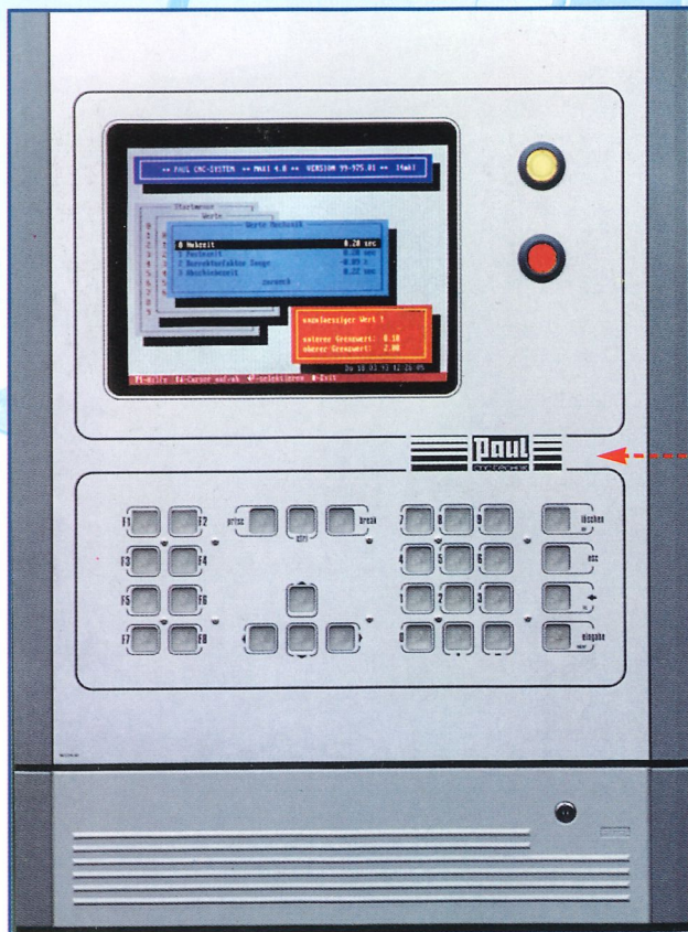
Abb. 6 NCK-3-Steuerung mit Leuchtdisplay und großen Tasten
