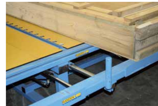
Ansicht der hydraulischen Breitereinstellung mit Verpressfunktion (BS2-HW3100HS)
