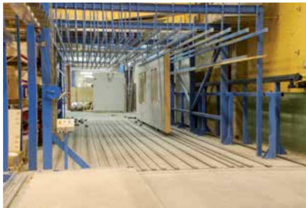
Ansicht eines vertikalen Lager-System. Kann direkt aus dem BS20-System gespeist werden, wenn mit der Option BS2-RVP ausgestattet.
