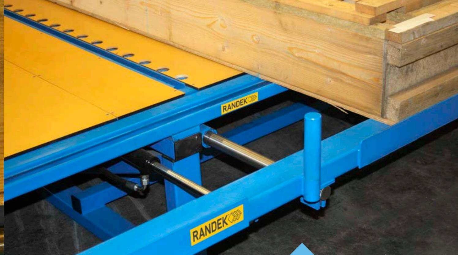
Ansicht mit hydraulischer Breite und Quadrierfunktion
