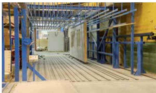
Widok przedstawiający magazyn pionowy. Elementy mogą być dostarczane bezpośrednio z systemu BS20 w przypadku wyposażenia w opcję BS2-RVP.
