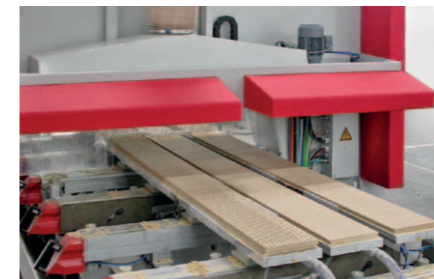
ARTIS mit Sonderspannvorrichtungen für die Bearbeitung von Türen, Möbeln, Tischen und Akustikplatten
