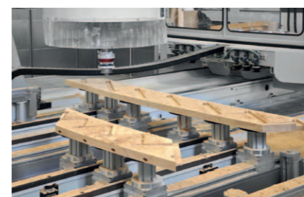
Bearbeitung von Treppenwangen auf einer ECO mit 2 automatischen Rüsttischen
