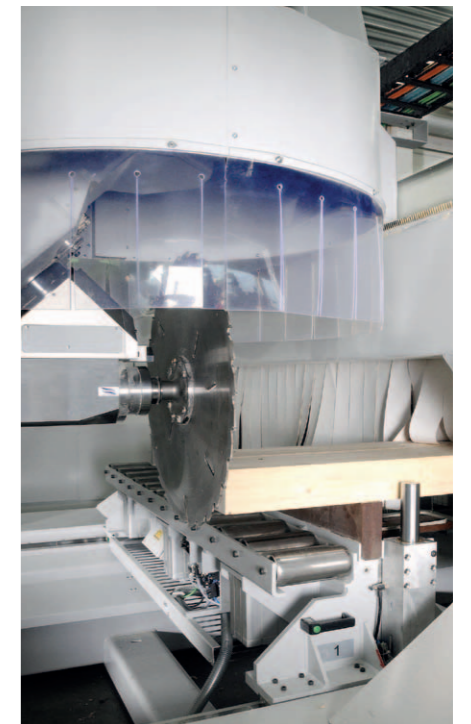
Leimbinder-Bearbeitung (bis 50 m) mit einem 5-Achs Arbeitsaggregat (Spindel 55 kW, Sägeblatt 800 mm)
