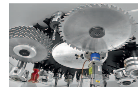
Mitfahrendes 24-fach Tellermagazin (max. WZ-Ø 300 mm)
