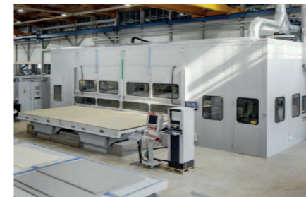
Bearbeitungszentrum vom Typ ECO mit koppelbaren Tischen zur Bearbeitung von Plattendimensionen bis zu 3,3 x 7,0 m
