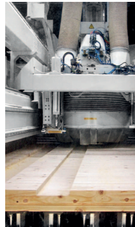
VISION-III-TT zur Bearbeitung von Holzhäuswänden bis zu einer Größe von 13.500 x 3.200 x 250 mm
