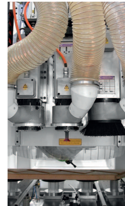
Arbeitsaggregate einer VISION-ST (Treppenfertigung), 5-Achs Aggregat mit drei zusätzlichen Fräsmotoren
