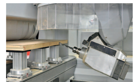
Kardanisches 5-Achs Arbeitsaggregat (Spindel 24 kW, unterschwenkend -20°) zur Bearbeitung von Massivholz
