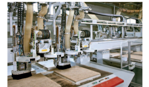
ECO mit 2 Tischen und 4 Aggregaten inkl. mitfahrenden 12-fach Werkzeugwechslern für Nestingbearbeitung
