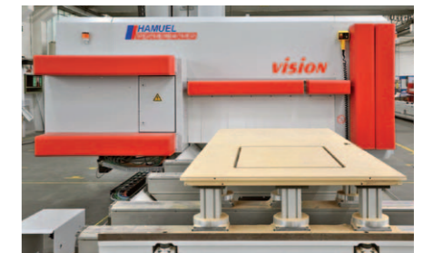
Türenbearbeitung mit Lichtausschnitt auf einer VISION mit automatischem Rüsttisch
