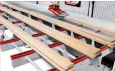
Die Maschine übernimmt die Werkstücke (Werkstückpakete) vollautomatisch aus dem Puffer. Somit ist eine kontinuierliche Auslastung der Säge möglich.
