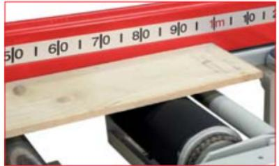
Optionaler Pendelantrieb, um das Werkstück an den Längenanschlag zu transportieren (pneumatisch oder hydraulisch)
