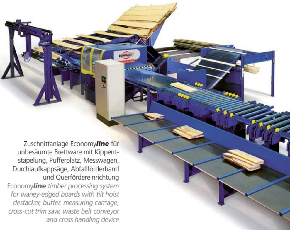
Zuschnittanlage **Economyline** für unbesäumte Brettware mit Kippentapelung, Pufferplatz, Messwagen, Durchlaufkappsäge, Abfallförderband und Querfördereinrichtung
