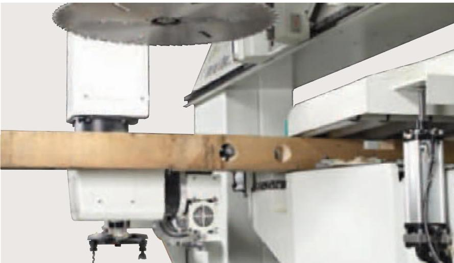
OIKOS RT4000, grâce à l'unité de fraisage indépendante à 5 axes, outrepassé les limites traditionnelles dans l'usinage des poutres.
