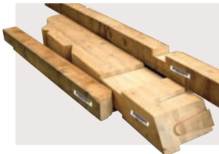
Per ottenere la massima efficienza in produzione è necessario ottimizzare la gestione delle travi a partire direttamente dallo scarico dalla macchina. Per questo OIKOS RT4000 è dotata di un sistema di espulsione pezzi che permette di avvicinare le travi pronte per essere prelevate con un sollevatore. Opportuni sistemi di marcatura ed etichettatura della trave permettono di riconoscere ogni singolo elemento agevolando la gestione aziendale e persino il montaggio in cantiere.
