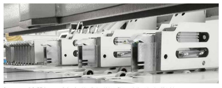
Spannzangen mit On/Off der pneumatischen Anschläge für beschichtete Platten mit überstehendem Material.
