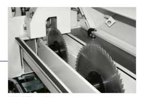
SAW-SET: das Werkzeugwechsel war noch nie so einfach Schnelle und präzise Werkzeugeinstellung dank der elektronischen Einstellung. (Opt.)
