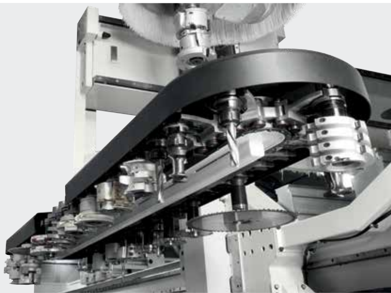
Die Maschine kann mit Werkzeughalter-Magazinen von bis zu 48 Plätzen für jedes Arbeitsaggregat ausgestattet werden.
