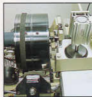
Pneumatic panel hold-down Pneumatische Plattenspannvorrichtung
