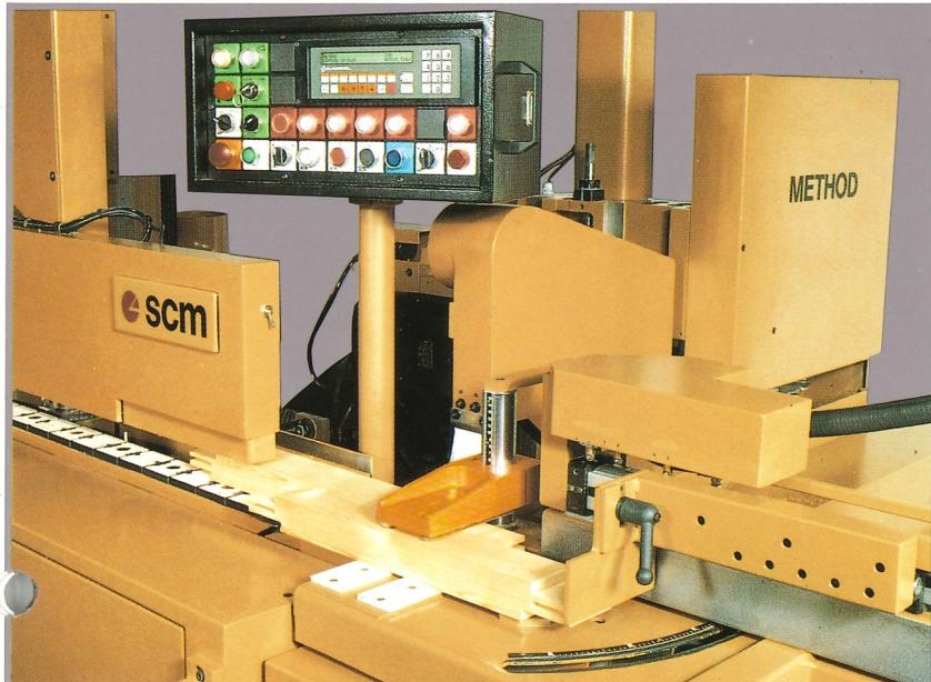
Possibilité d'usiner en séquence des pièces de n'importe quelle largeur sans perte de temps, parce qu'il n'y a aucun guide à régler.
