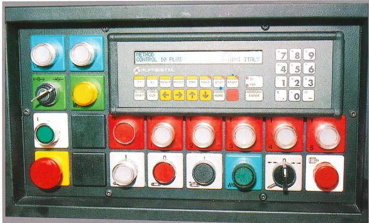
Le METHOD est en mesure d'usiner n'importe quelle pièce sans aucune clef; l'opérateur peut dialoguer directement avec l'ordinateur dans sa propre langue (italien, français, allemand ou anglais au choix à partir du clavier) aussi bien durant la phase de programmation que durant l'exécution. La puissance élevée de l'ordinateur réduit au minimum le nombre d'informations qui doivent être gérées et les opérations à faire, tout se réalise après avoir écrit **uniquement le numéro du programme**:
