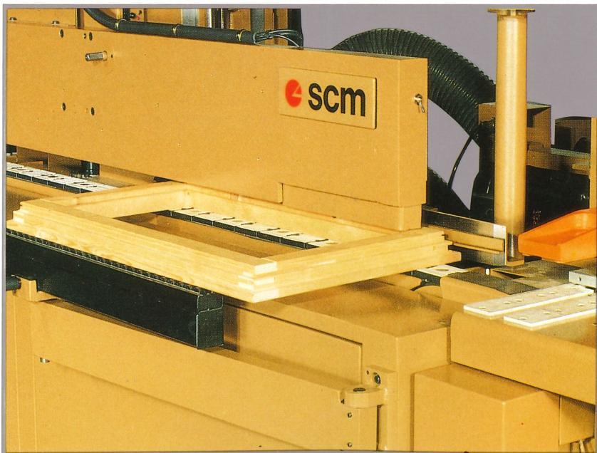
Passage rapide du profilage intérieur des pièces au profilage extérieur des ouvrants sans aucune mise au point.
