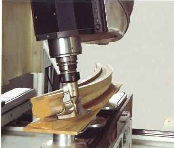
Interpolation in 5 axes: Prisma opens new application possibilities. 5 Achse Interpolierung: Prisma bietet neue Einsatzmöglichkeiten.
