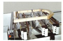
Quick release rotating clamps and double movement lifting units make it easy for assembled sash positioning and for trimming operations. Drehbacken und Heber mit zwei Bewegungsrichtungen erlauben eine bequeme Anordnung der zu formatierenden Flügel.
