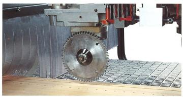
Independent Sawing Blade Unit. Unabhängiges Sägeaggregat
