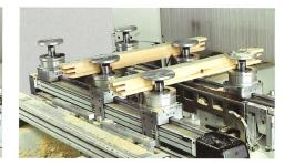
Ideal für die vollständige Automatisierung bei der Fertigung von vormontierten Türen und Fenstern.
