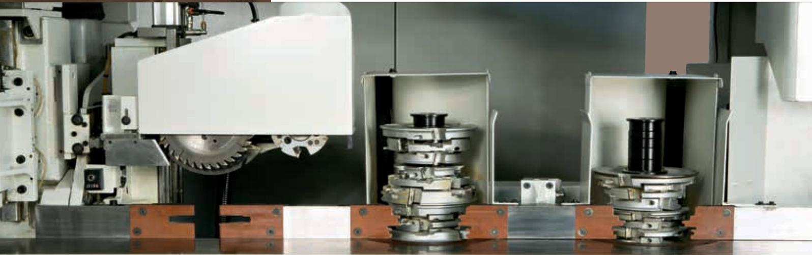
Per soddisfare tutte le esigenze di profilatura, sono disponibili due alberi a profilare 50x320 mm ad alta precisione. Questi gruppi sono dotati di regolazione orizzontale pneumatica a 5 posizioni. Possono essere alloggiati utensili con diametro min/max 130/240 mm.
