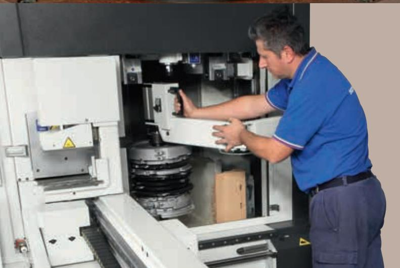
Grazie ad un dispositivo manuale di cambio mandrino, l'operatore è in grado di effettuare il cambio utensile con estrema facilità e nella massima sicurezza, anche per utensili di grandi dimensioni.
