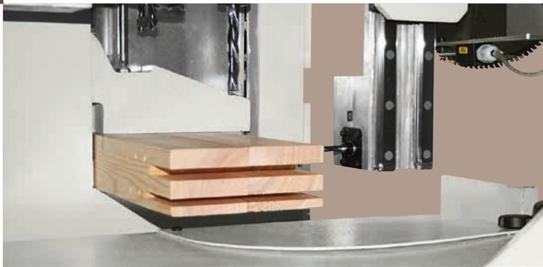
Su Windor NT1 è possibile prevedere una unità di fora-fresatura in tenonatura per le lavorazioni accessorie; il pezzo esce pronto da assemblare.
