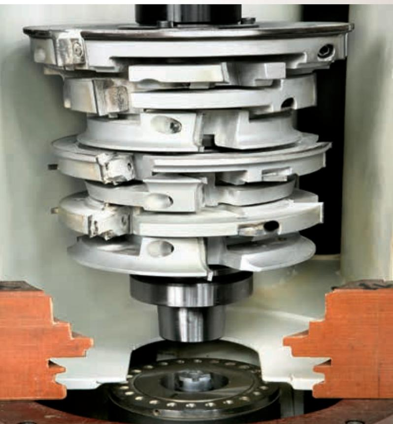
Windor NT1 può essere equipaggiata con alberi intercambiabili HSK 85S sia in tenonatura che in profilatura.
