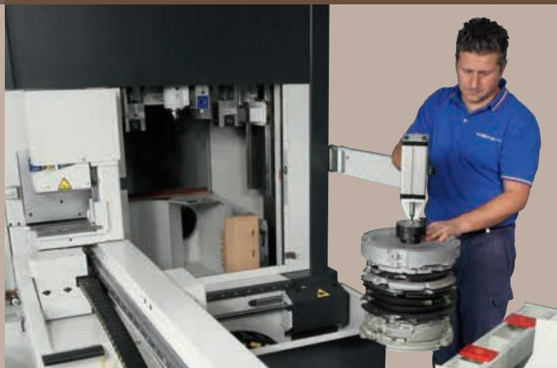
Gracias a un dispositivo manual de cambio mandril, el operario puede efectuar el cambio de la herramienta con extremada facilidad y máxima seguridad, incluso en caso de herramientas de grandes dimensiones.
