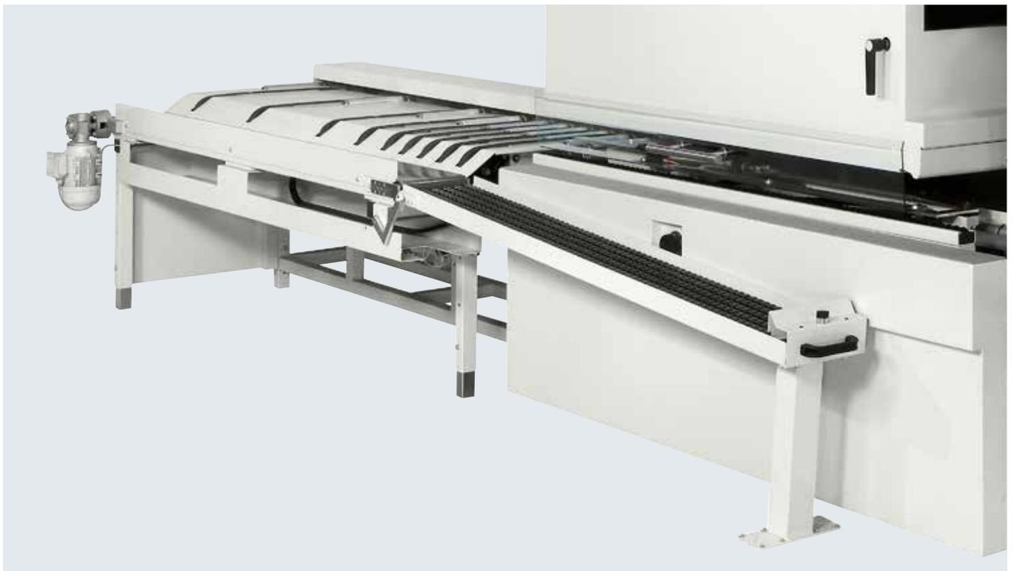
Keine unproduktive Zeit mit dem Rückführungssystem an den Bediener am Maschinenausgang.
