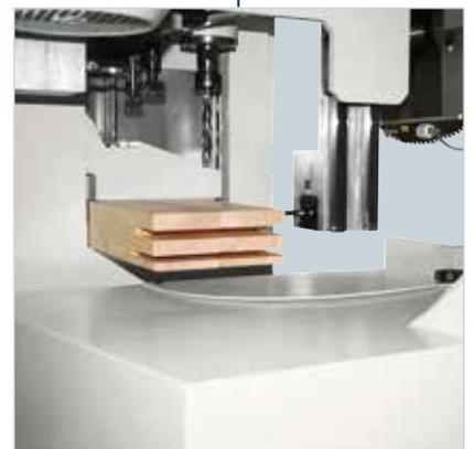
*Bohr- und Fräsaggregat
