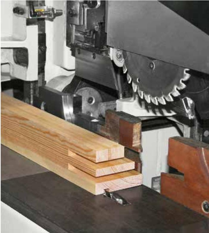
Horizontalspindel zur Bearbeitung der Werkstückunterseite.
