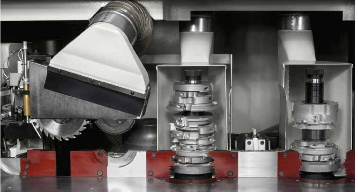
Keine Einschränkung bei den Profilen, die man fertigen kann: je nach Anforderungen beim Längsprofilieren sind zwei Profilspindeln 50x320 mm erhältlich mit einer pneumatischen Horizontaleinstellung mit 5 Positionen ausgestattet. Es können Werkzeuge mit einem Mindest-/Maximaldurchmesser von 130/240 mm eingesetzt werden.
