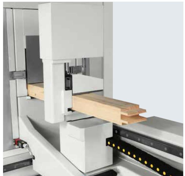
Das Spannen der Werkstücke erfolgt über einen zentralen Zylinder mit elektronischer Positionierung, die je nach Länge des Werkstücks arbeitet. Durch die Zange ist das bestücken ganz leicht und das Werkstück wird sicher gespannt, auch wenn zwei Hölzer zusammengespannt werden.
