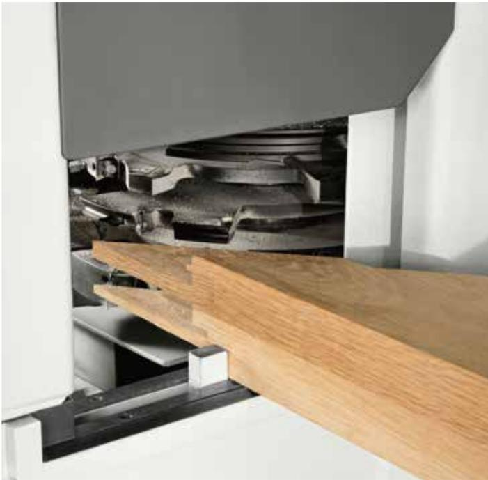
Die Herstellung von schrägen Zapfen durch die interpolierende Bewegung des Zapfenschneidtisches: eine Lösung aus den hochentwickelten Maschinen bei geringen Kosten und in der Standardausstattung.
