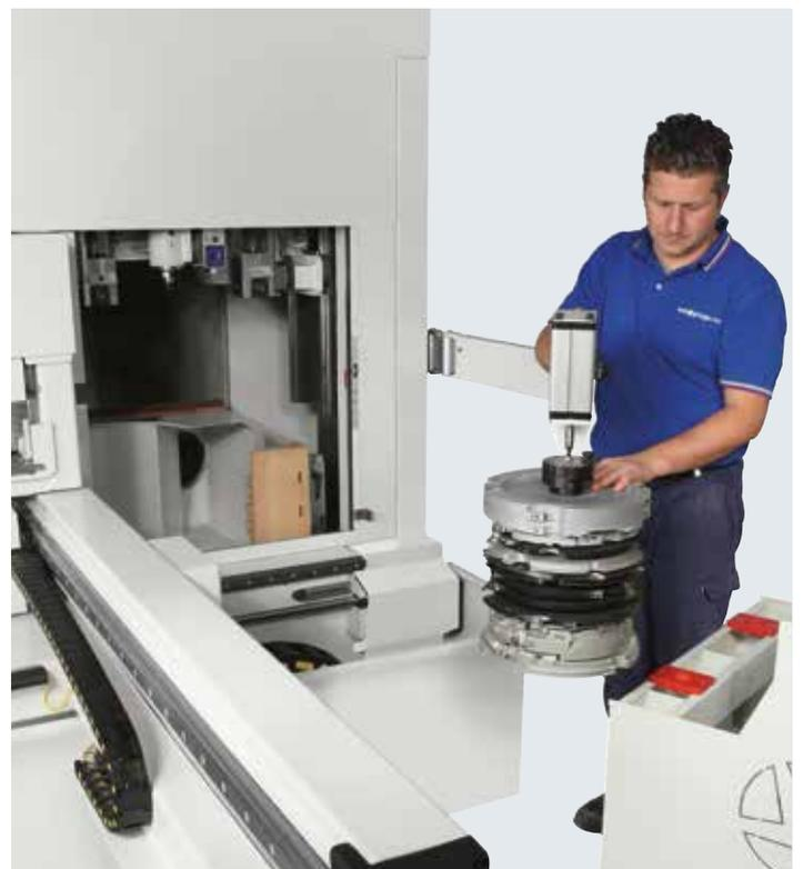
Bei Spindeln mit "HSK" Werkzeugaufnahme, mithilfe einer manuellen Vorrichtung zum Wechsel der Spindel wird der Werkzeugwechsel für den Bediener ganz einfach und extrem sicher.
