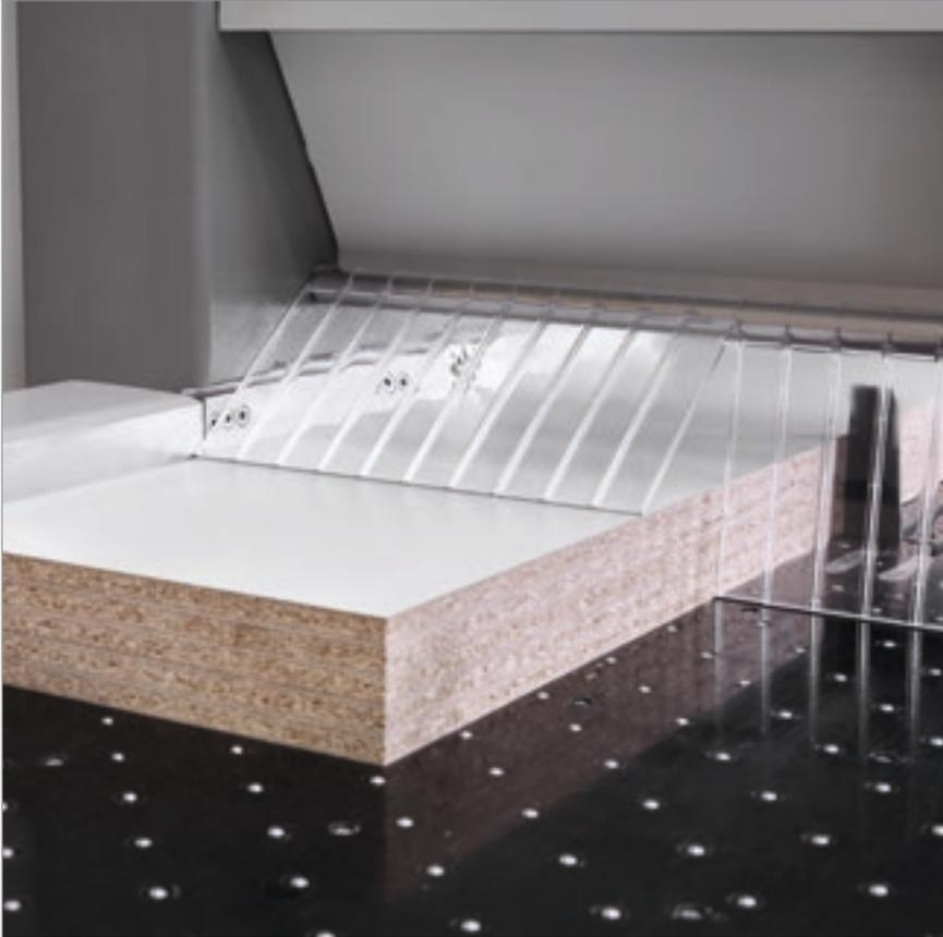
Der Anschlag für die seitliche Ausrichtung der Platten ist in den Quersägewagen integriert. Seine Beschaffenheit ermöglicht die perfekte Ausrichtung sogar von sehr dünnen und/oder flexiblen Platten und verkürzt dadurch die Zyklusdauer auf ein Minimum.
