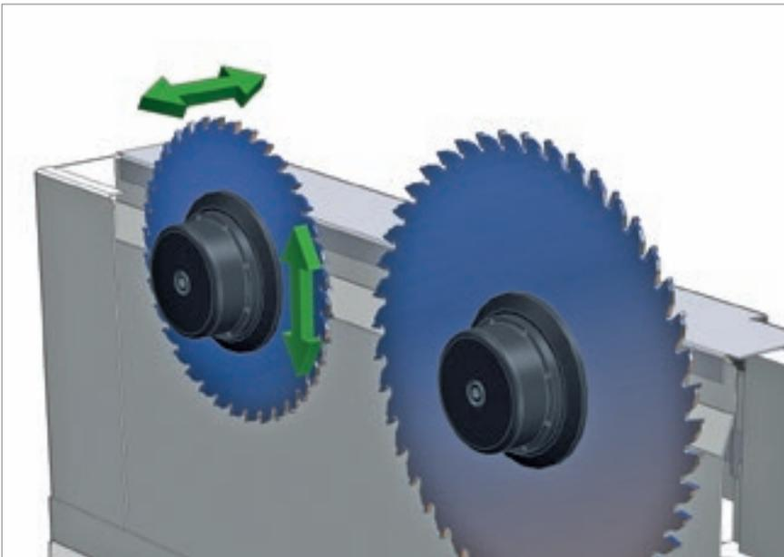
Schnelle und präzise Werkzeugeinstellung durch die elektronische Regulierung des Vorritzers mit der „Digiset“ Vorrichtung.
