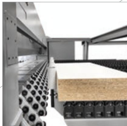
Die Besäumschnitte in Längsrichtung werden über eine komplett automatische, auf freilaufenden Rollen gleitende Schleuse ausgeworfen.
