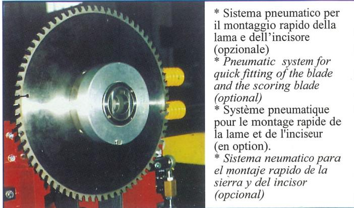
\* Sistema pneumatico per il montaggio rapido della lama e dell'incisore (optional)
