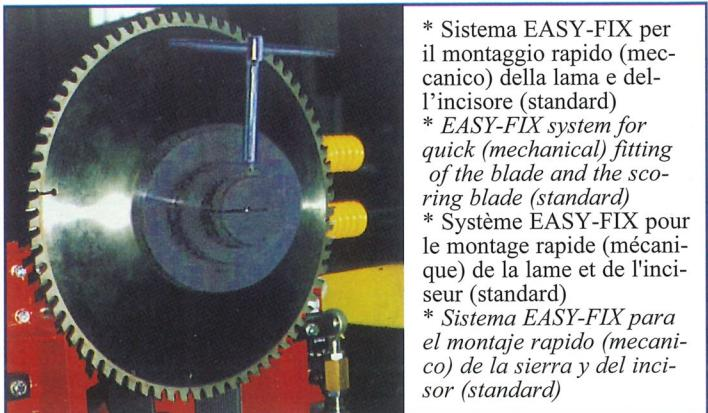
\* Sistema EASY-FIX per il montaggio rapido (meccanico) della lama e dell'incisore (standard)
