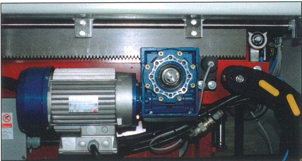
\* Traslazione del carro lame, a velocità regolabile dal quadro comandi a mezzo di inverter, a pignone e cremalliera, con corsa programmata dal computer.
