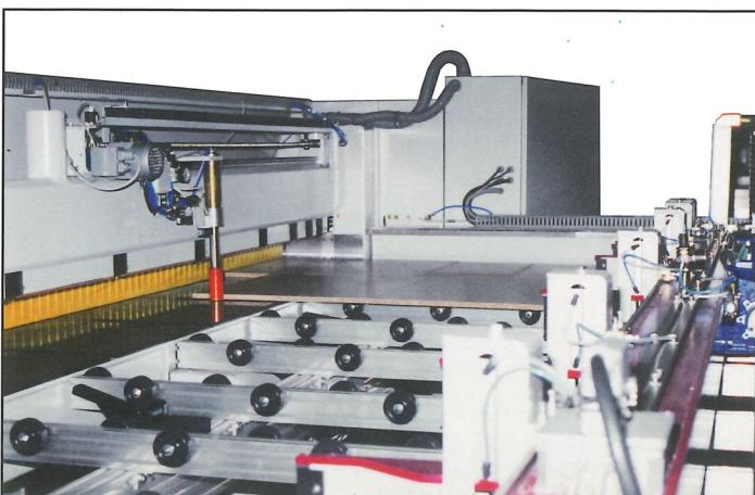
\* Impaccatore laterale (S 2000, S 2000 T), gestito automaticamente dal programmatore elettronico con corsa automaticamente adeguata alla larghezza del pannello
