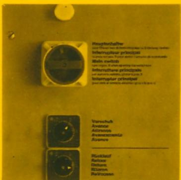
Optimale, dem Schnittgut und dem Arbeitsrhythmus angepaßte Vorschubgeschwindigkeit – Vor- und Rücklauf sind unabhängig voneinander zwischen 11 und 33 m/min einstellbar.
