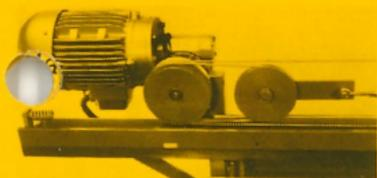
Keine aufwendige Pneumatik – ein einziger Spezialmotor steuert über ein genial einfaches Seilzugsystem alle Bewegungsabläufe der Säge, nämlich:
