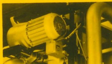
● Eintauchvorrichtung für problemloses, selbsttätiges Eintauchen des Säge-Aggregates auf Über-Kopf-Höhe bei Senkrechtschnitten — im Bereich von 50 cm höhenverstellbar.
