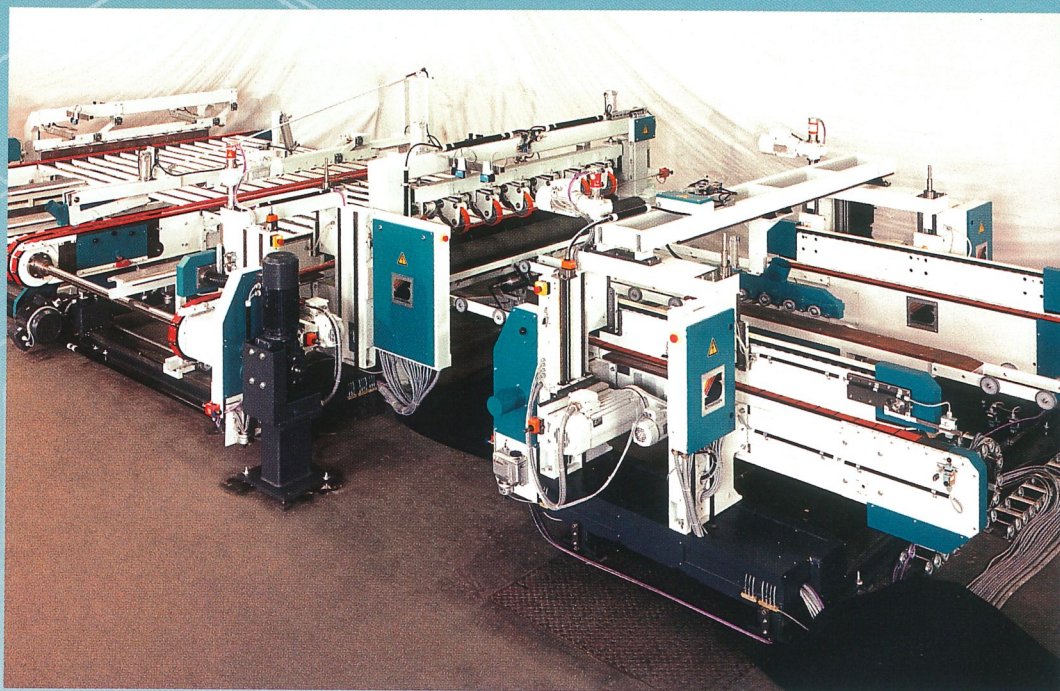
Besäumung und Aufteilung von Einzelplatten
