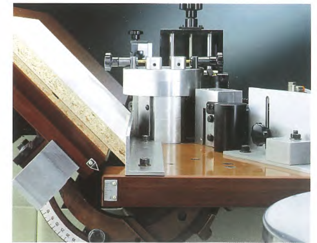
Bordatura di pezzi a 45°. 45° Pieces edging. 45 Graden Kanten. Placage de pièces à 45°. Canteado de panales a 45°. Orlagem de peças a 45°.
