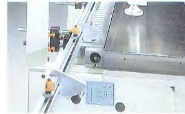
Barra metrica con 4 battute. Alu fence with 4 stops. Stange mit 4 Anschlägen. Regle avec 4 butées. Barra métrica con 4 topes. Paralela com 4 batentes.
