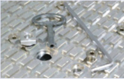
1" Vakuumschlüsse mit Schnellöffnung mittels Schaltschranckschlüssel, Vakuümöffnungen mit Feingewinde zur Befestigung von Spannmitteln
