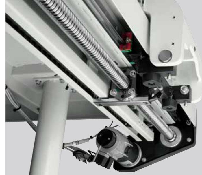
Guida parallela motorizzata "Versione AX"
