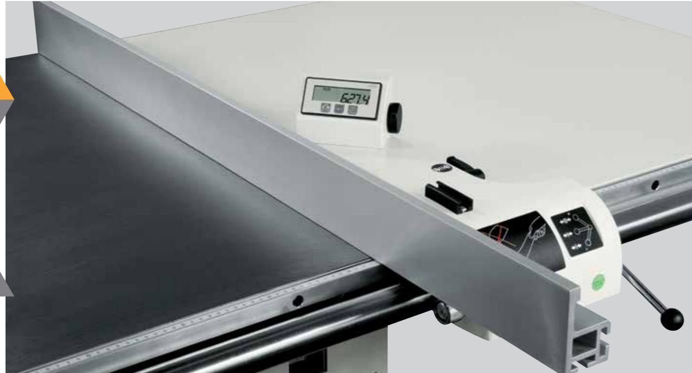
Lettore elettronico della posizione della guida parallela
