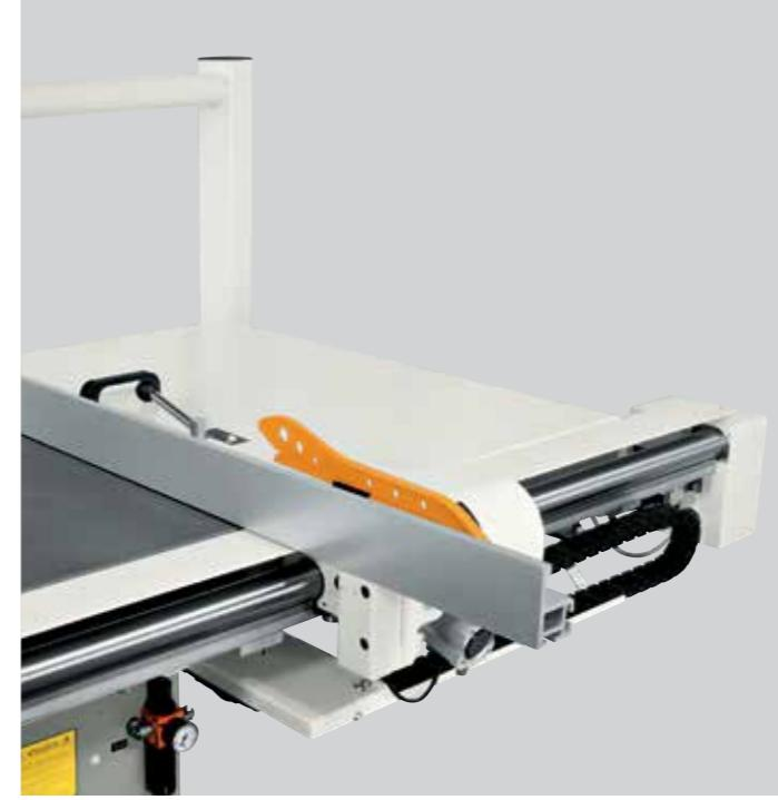
Guida parallela motorizzata "Versione A"
