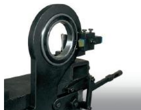
Lunetta mobile con utensile Fixed steady with tool Moving steady with tool Lunette mobile avec outil Bewegliche Lünette mit Werkzeug Lunilla movil con utensilio Подвижное устройство с инструментом
