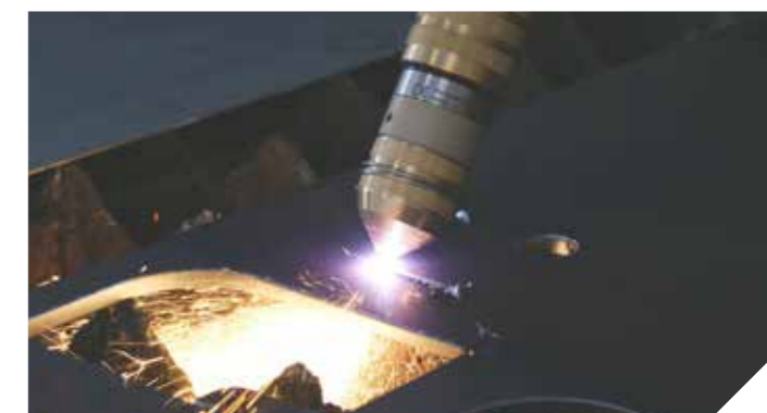
Coupe chanfrein d'une tôle avec une découpe plasma.
