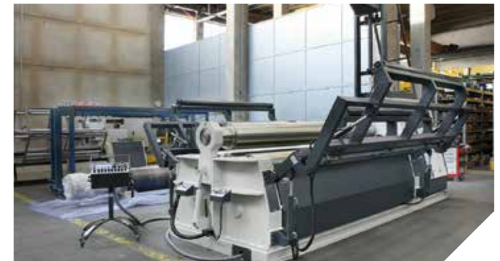
Rouleuse 4 rouleaux capacité 3 m épaisseur 28 mm, avec support central et bras latéraux.
