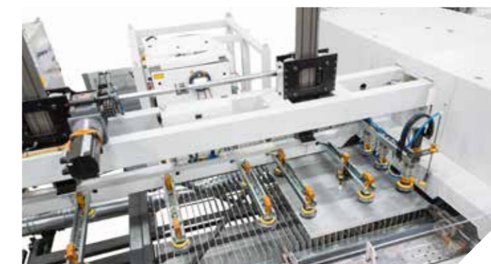
Chargement et déchargement automatique avec chariot frontal.
