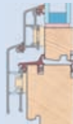
über die Steg-Dichtung und Aluschale
