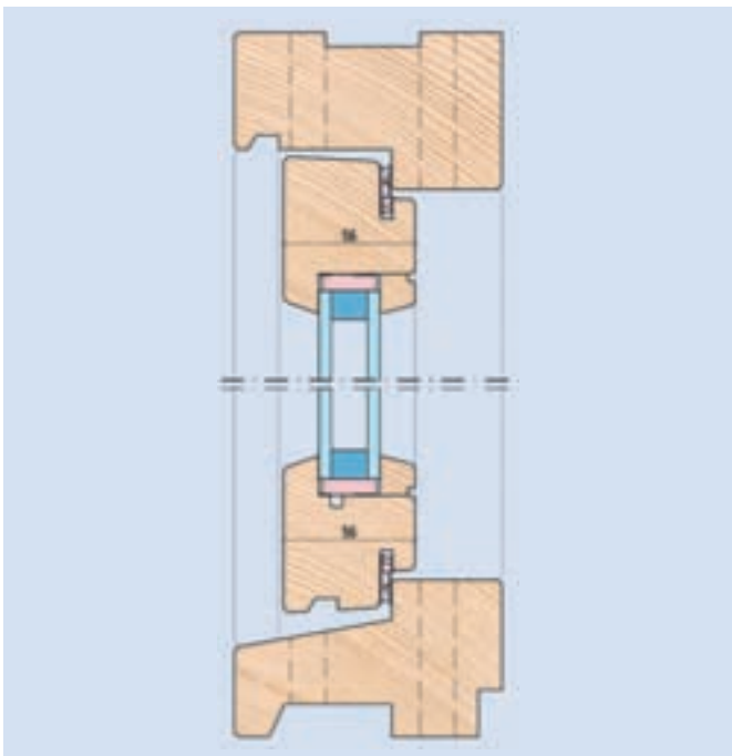
Außendrehend mit Einfachfalz und Flügeldichtung. Typisch für Niederlande
