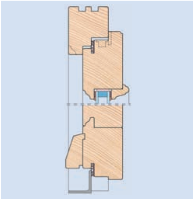
Haustüre Doppelfalz mit Winkelschiene
