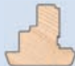
Kombination Rahmen- und Flügelprofil für Festverglasung
