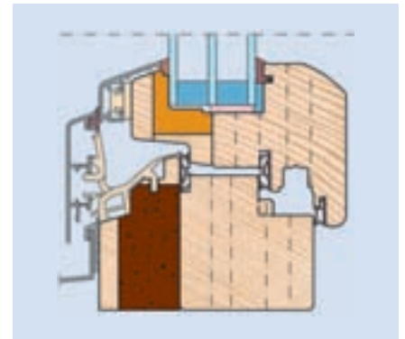
Varitherm M Zweiteilige Rahmenkonstruktion in Holz/Alu, Dämmrahmen mit Verbundkantele aus Holz/Kork U_w -Wert 0,8 W/m 2 K
