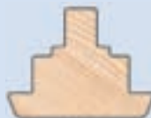
Kombination Rahmen- und Flügelprofil für Festverglasung
