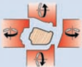
Aus einer Vierkant-Rohleiste kann eine überfalzte Glasleiste mit optimaler Oberfläche mittels Auflage auf der Sichtseite produziert werden
