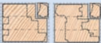
3 Leisten aus Rahmen innen seitlich und oben 4 Leisten aus Flügel außen seitlich, oben und unten
