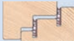
Doppelfalz Mitteldichtung im Flügel umlaufend. Unten alternativ ohne Türüberschlag
