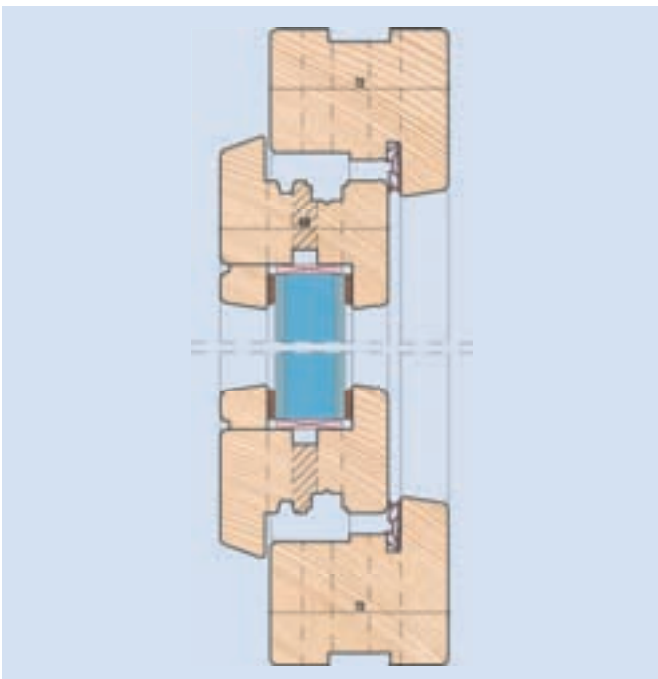
Außenöffnend mit Einfachfalz und Rahmendichtung Stormproof Casement. Typisch für Großbritannien
