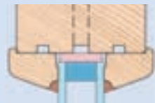
Rahmentür mit beidseitig aufge- setzten Leisten
