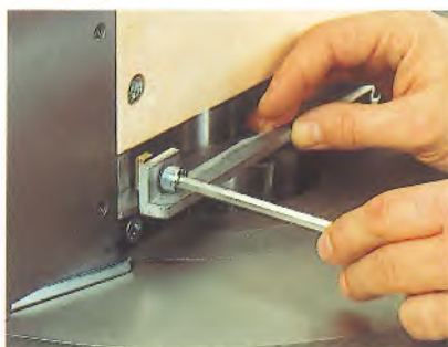
Einsetzen der Gleitsteine von vorne. Stufenlose Höhenverstellung der Lineale.
