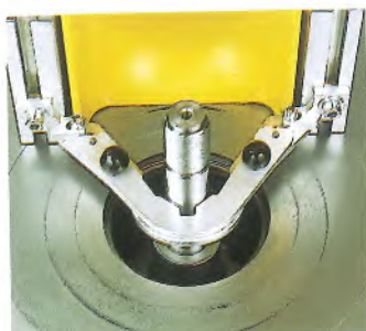
Zentriervorrichtung auf Anlaufring aufgesteckt.
