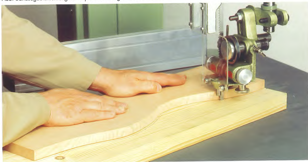
Abb. Bandsägeblattführung mit Kopiereinrichtung und Schutzschild.
