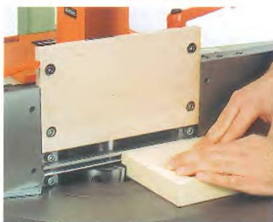
Sicherheitslineale zur Werkstückführung, Kehl Brett als Spindelabdeckung.
