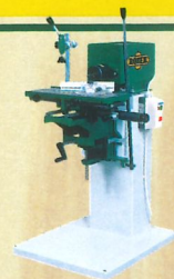
СВЕРДЛИЛЬНО-ПАЗУВАЛЬНИЙ VDA 316 розміри столу 460x190 мм, діаметр кріплення - 0-16 мм, потужність - 2,2 кВт, хід столу - поздовжній 220 мм, поперечний 135 мм, частота обертання 2860 об/хв
