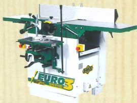
ФУГУВАЛЬНО-РЕЙСМУСНИЙ MSP 415 (315) ширина обробки - до 400(300)мм, висота обробки - до 230мм, 4 ножі, потужність - 3(2,2) кВт, швидкість подачі - 8/12 (8) м/хв, відкидні столи, опція - довбальний пристрій VDA 315
