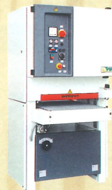
РЕЙСМУСНО-ШЛІФУВАЛЬНО-КАЛІБРУВАЛЬНИЙ BSH 650 ширина обробки 650 мм, модель: рейсмусний вал + однострічковий з "утюжком" ( HP ), товщина обробки 3 - 160 мм, швидкість шліфування 18 м/хв., потужність 5,5 (7,5; 11 ) кВт
