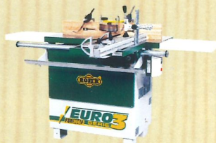
ФРЕЗЕРНИЙ FSN 300F діаметр шпинделя 30 мм, частота обертання -1,4-3,5-6- 8000 об/хв, потужність 2,2 (3) кВт, розміри столу 1000 x 476 мм, опції - каретка CV1C, подовження столу
