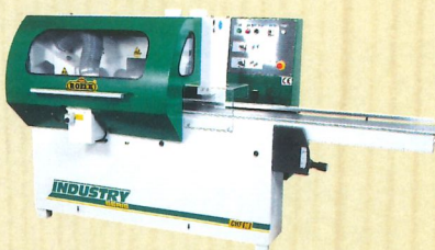
ЧОТИРИСТОРОННИЙ ПРОФІЛЬНИЙ SNF 18/4 мін/макс. перетин обробки 23x7,5 мм / 180x120 мм, кількість шпинделів - 4 шт., швидкість подачі 6/12 м/хв, потужність 2x7,5 кВт
