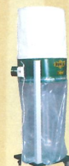
АСПІРАЦІЯ R 3000 продуктивність 3900 м 3 /год, кількість пилозбирачів 1 шт. потужність 1,1 кВт, діаметр відсосу 140 мм
