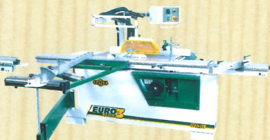
ФОРМАТНО-РОЗКРИЙНИЙ PF 300 L довжина різі 3000, 2600 мм, потужність 3(4; 5,5) кВт, ширина різі 1050(1500)мм, характеристика пил: D=300/30, d=100/20, нахил пил +90°- 45°, окремий підрізний електродвигун 0,55 кВт, опції - кутова лінійка
