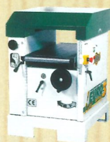
РЕЙСМУСНИЙ MP 415 (315) ширина обробки - до 400 (300)мм, висота обробки - до 230мм, 4 ножі, потужність - 3 (2,2) кВт, швидкість подачі - 8/12 (8) м/хв
