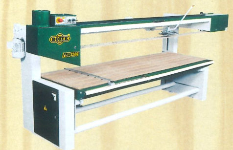
ШЛІФУВАЛЬНИЙ З РУХОМИМ СТОЛОМ PBD 2200 (2500; 3000) розміри столу 2200(2500; 3000) x 800 мм, швидкість шліфування 17 - 35м/с, потужність 2,2/3 кВт або 3/3,7 кВт
