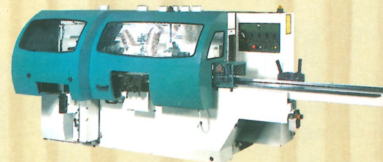
ЧОТИРИСТОРОННИЙ ПРОФІЛЬНИЙ SPF 180 (220, 240) мін/макс. перетин обробки 25x7 мм / 180(220, 240) x120 (160) мм, кількість шпинделів - 4, 5, 6 шт., швидкість подачі 7/14 (4-22) м/хв,
