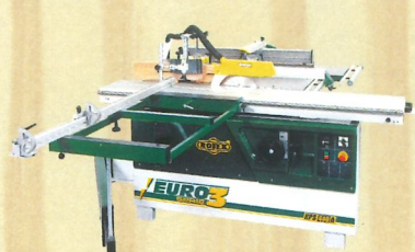
П'ЯТИОПЕРАЦІЙНИЙ KPS 300 (400) ширина обробки фугування/рейсмусування 300(400) мм, 4 ножі, діаметр шпинделя 30мм, частота обертання 1,4-3,5-6- 8000 об/хв, довжина різі 1100мм, ширина різі 670мм, нахил пил +90°- 45°, характеристика пил: Dmax=300мм, D=250/30, d=80/20, потужність 3x2,2 (3x3) опції: каретка CV2B, довбальний пристрій VL
