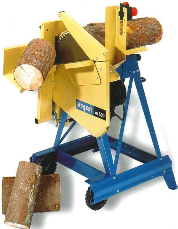
Mehr als ein halber Meter Schnitttiefe – die Wippkreissäge schepach kw 7. Die über dem Sägeblattlager angeordnete Holzauflage ermöglicht bei der kw 7 eine Schnitttiefe von 27 cm – im Wendeschnitt also über einen halben Meter.
