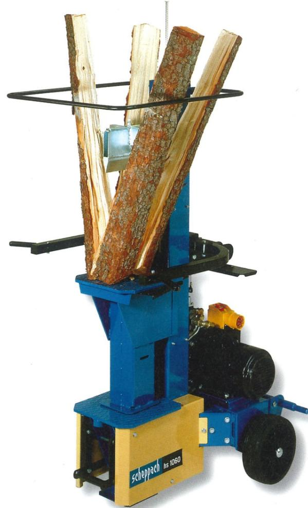
Der starke Motor in Verbindung mit der Hydraulikanlage treibt den Spaltkeil auch durch schwieriges, faseriges Holz. Der doppelt wirksame Hydraulikzylinder zieht den Keil wieder schnell nach oben. Dicke Stücke zerlegt das Spaltkreuz in vier handliche Teile. Auf diese Weise gespaltenes Meterholz läßt sich mit einer schepach Wippkreissäge mühelos zerkleinern.
