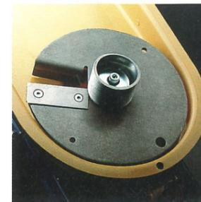
Das Wendemesser aus Spezialstahl auf der schrägliegenden Messerscheibe zieht und häckseln in einem.
