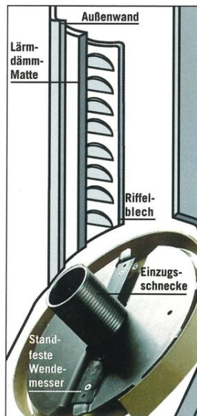
Das Einzug-Schrägschnitt-System mit den Messern im 45-Grad-Winkel ist patentiert und damit konkurrenzlos.
