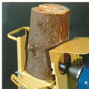
schepach Wippkreissägen können auch spalten. Der nachrüstbare Spalter zerteilt bis zu 40 cm dickes Holz.
