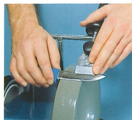
Schleifvorrichtung SVM-45 für Messer, ab Klinglänge ca. 120 mm - SVM 100
