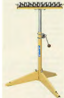
Allseiten-Rollbock ASR äußerst leichtgängige Rollelemente (48 x 390 mm) aus Kunststoff, stufenlose Höhenverstellung von 690 bis 1010 mm, max. Belastung 80 kg Bestell-Nr. 7904 0000
