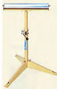
Rollbock RB Rollen \varnothing 50 mm x 400 mm, stufenlose Höhenverstellung von 550 bis 910 mm, max. Belastung 120 kg Bestell-Nr. 7901 0000
