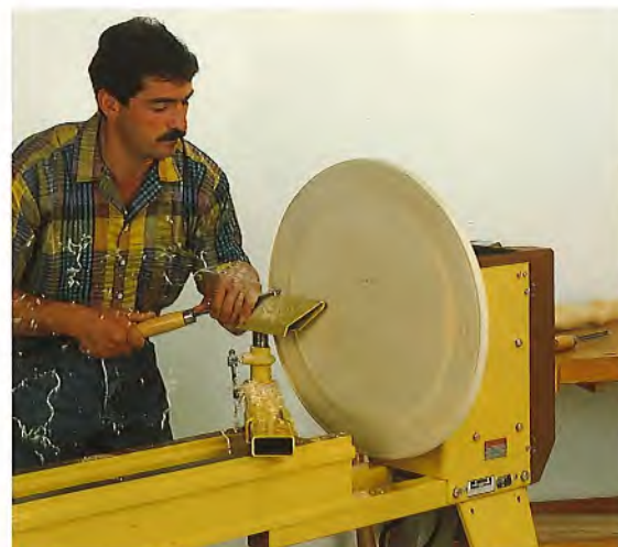
Ausziehbares Maschinenbett für Spitzenhöhen bis max. 315 mm und Spitzenlängen bis max. 1100 mm
