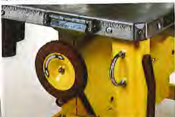
Robustes Handrad für leichtgängige Höhenverstellung
