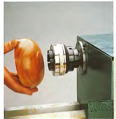
Spannzangenbacken 50,8 mm Bestell-Nr. 7400 9501
