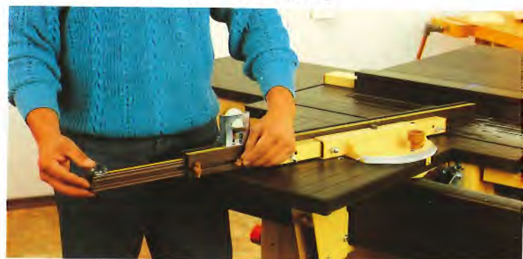
Anschlagschiene mit integrierter Verlängerung.
