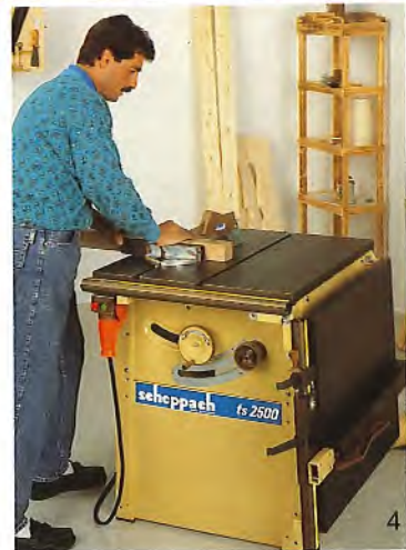
1 | Von oben bequem einsetzbarer Präzisions-Längsansschlag
