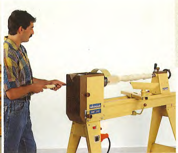
Einsatz des Löffelbohrers durch die Hohlspindel
