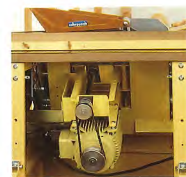
Sägeblatt-Antrieb über Hochleistungs-Keilriemen
