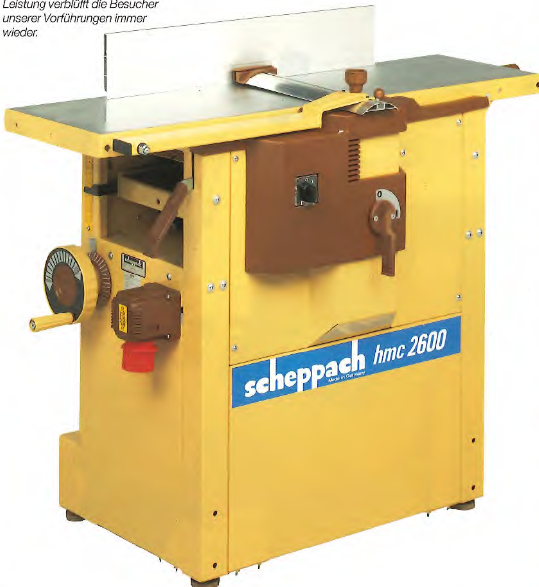
Das praktische Sichtfenster zum Einstellen der Spanabnahme
