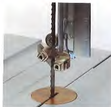
Flachführung des Sägebandes aus Sintermetall
