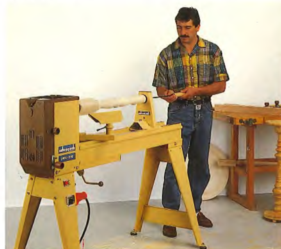
Einsatz des Löffelbohrers mit Bohrsetzstock
