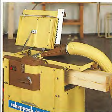
Späne-Auswurfhaube beim Dickenhobeln.
