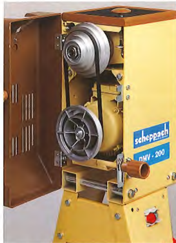
Deutlich ruhigerer Lauf durch Poly-V-Riemen.
