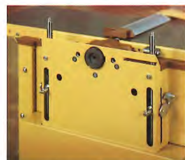
scheppach 4-Punkthalterung für die Anbaugeräte
