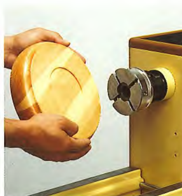
Einsatz des Spreizbackenfutters beim Drehen einer Scheibe
