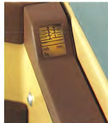
Das praktische Sichtfenster zum Einstellen der Spanabnahme
