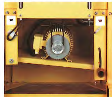
Der scheppach 2-Riemenantrieb
