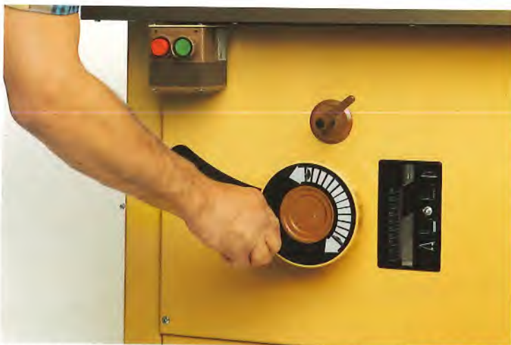
Handrad drehen: ▲ Schnitthöhen-Einstellung
