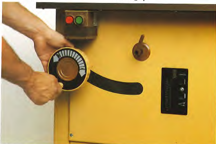
Arretierung lösen, Handrad ziehen und drehen: Schnittwinkel-Einstellung ▼
