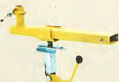
Klemm-Einrichtung zu Werkzeug-Auflage, 650 mm lang nur für DMV 200 Bestell-Nr. 7400 5000
