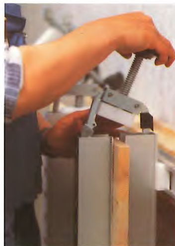
Handrad zum Zusammenpressen der scheppach Verleimpresse plano.
