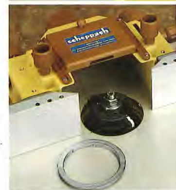
Die Tischöffnung läßt sich durch Herausnehmen des Spindelringes von 112 auf 135 mm vergrößern. Jetzt können Sie zum Beispiel den Universal-Fräskopf einschließlich Profilmesser auf das gewünschte Maß absenken.
