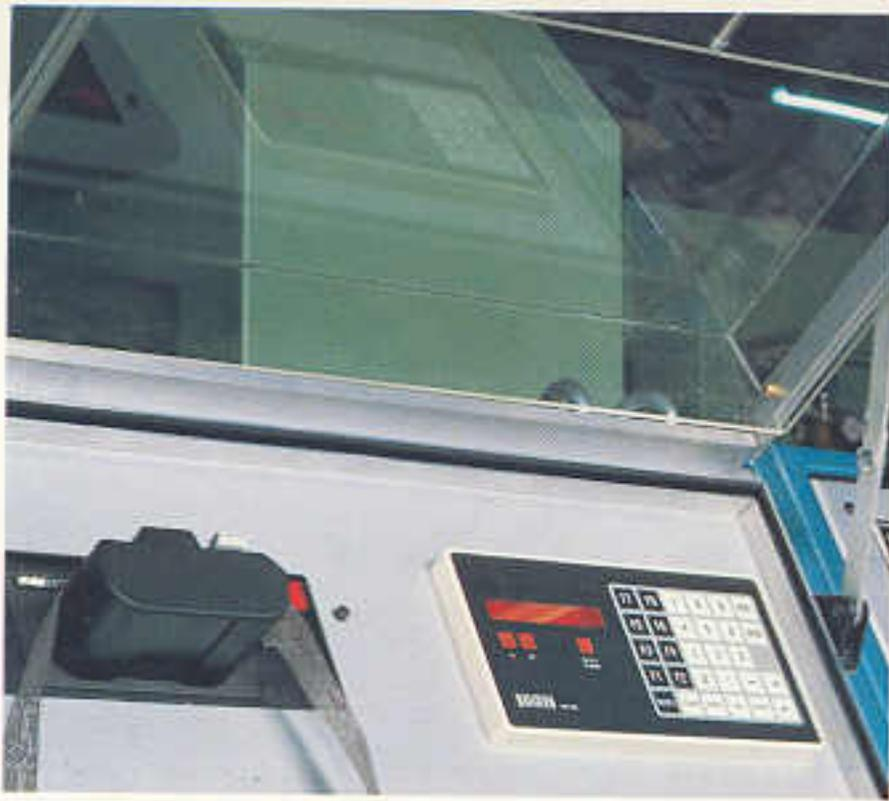
Oltre al GIBEN OPTICUT II°, il calcolatore atto ad individuare schemi di taglio ottimali e capace di fornire direttamente, via cavo, le "istruzioni" alla sezionatrice, sono state progettate, sperimentate e realizzate numerose altre unità elettroniche capaci di guidare il lavoro delle macchine Giben, sia nella esecuzione del taglio che in quella di smistamento dei sottomultipli.
