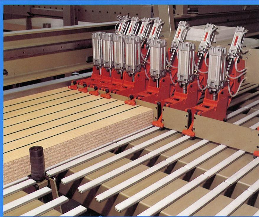
L'impianto è provvisto di un sistema di controllo computerizzato Giben, a microprocessore, con visualizzazione grafica dello schema di taglio e delle varie fasi di sezionatura e con autodiagnosi in tempo reale. È inoltre possibile il caricamento dati "on-line" direttamente dal software di ottimizzazione Giben Optisave.
