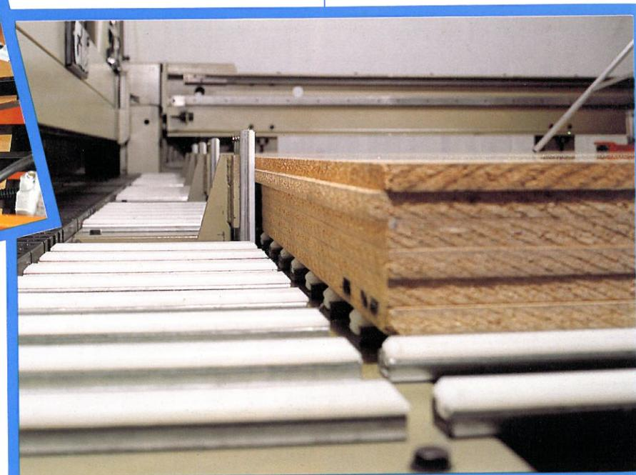
schen Ablauf ein- und ausgesteuert (Giben Patent). Durch dies und den Gleichstrommotor wird ein schnelles und präzises Abschieben der Pakete gewährleistet. Auf Anfrage ist eine automatische Einrichtung zum Abschieben von dünnen und welligen Platten vom Hubtisch lieferbar. Frontalausrichter führen eine perfekte Ausrichtung vor der Längsaufteilung durch.
