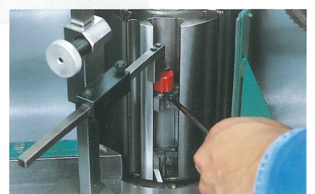
Grundausrüstung: TERSA-Vollstahlwelle mit Aufnahme für Profilmesser
