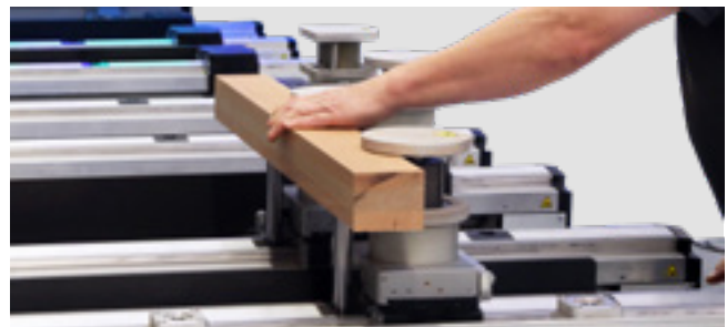
Die Anschlagbolzen in den Konsolen garantieren eine exakte Positionierung der Spannmittel für eine hochpräzise Einzelteillfertigung von Fensterprofilen ohne „Umfälzen“ der Rahmen. Zusätzlich werden die Anschlagbolzen als Einlegehilfe für breite Kanten genutzt. Dieses patentierte Prinzip garantiert eine exakte Querprofilierung unabhängig von der Teilebreite.
