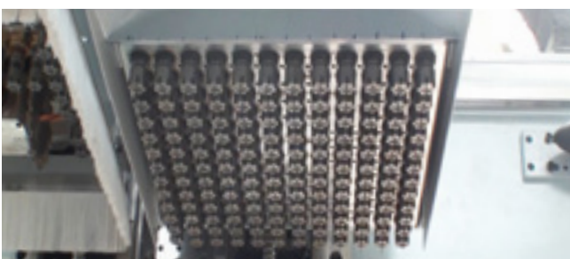
Bohraggregat 144 Spindeln: Zeitgleiches Bohren von 144 Löchern, z. B. für den Einsatz bei Akustikplatten. Spannanzgen für die Aufnahme unterschiedlicher Schaftdurchmesser. Aggregat fest aufgebaut auf den Aggregateträger.
