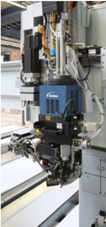
powerEdge mit PU-Aufschmelzeinheit: Kantenanleimen mit dünner Klebefuge und hoher Feuchtebeständigkeit
