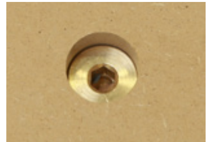
Hohlschraube: Hohlschrauben für die formschlüssige Befestigung von Schablonen oder Schonplatten in den vorhandenen Vakuumöffnungen. Bei der Ausführung für die Schablonenbefestigung kann das Vakuum über die Bohrung in der Schraube in die Schablone geführt werden.
