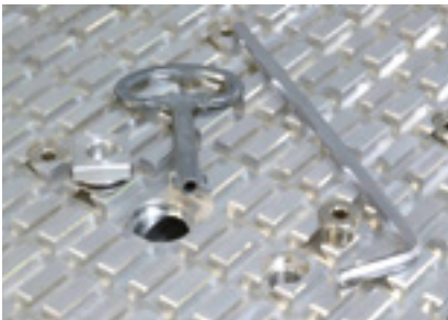
1" Vakuumanschlüsse mit Schnellöffnung mittels Schaltschrankschlüssel, Vakuumöffnungen mit Feingewinde zur Befestigung von Spannmitteln
