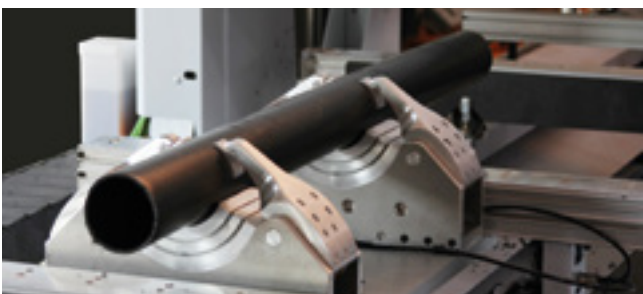
Spannvorrichtung für Rundrohre: Spannvorrichtung für die 5-Achs-Bearbeitung von Kunststoff-Rundrohren.
