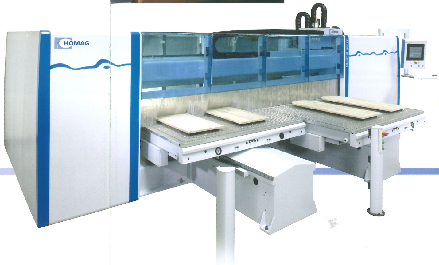
Bearbeitungszentrum Optimat BOF 611 mit optionaler Vollkapselung
