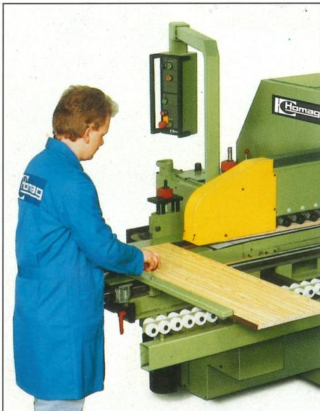
Bei manueller Bedienung ermöglichen Zusatzeinrichtungen leichteres Arbeiten und exaktere Ergebnisse (Abb. links).
