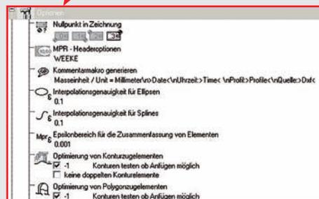
Mit Hilfe eines voreingestellten Regelwerkes können aus den DXF-Dateien alle Zeichnungselemente in Bearbeitungen umgewandelt werden.
