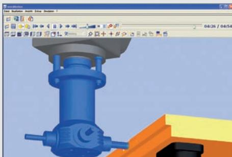
Einfaches Anlegen von profilierten Werkzeugen durch Übernahme einer in woodWOP gezeichneten Werkzeugkontur
