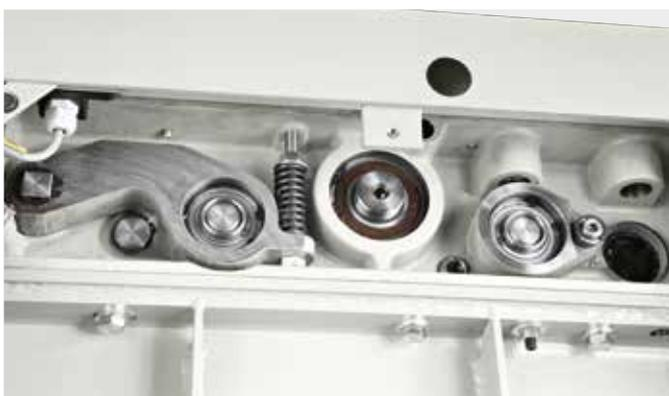
Feed rollers mounted on independent floating ball-bearing bushes. *Rouleaux d'entraînement supérieurs, montés sur roulements à billes, supportés par des bielles indépendantes et pivotantes.*
