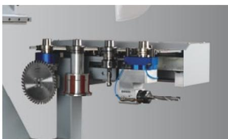
**2 4-fach-Linearwechsler in der X-Achse mitfahrend**
