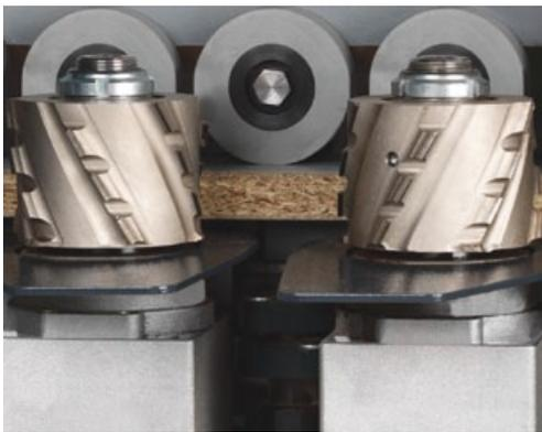
Bereits in der Standardausstattung mit Fügefräs- und Eckenrundungsaggregate für optimale Ergebnisse ohne Kompromisse!
