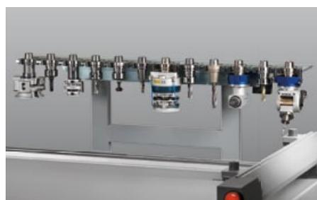
**4 12-fach-Linearwechsler, am Maschinenständer montiert**
