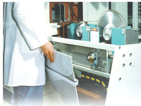
Speziell konstruierte schalldämpfende Seitenabdeckungen; sie ermöglichen trotzdem einen bequemen Zugang zu allen Anlagenbereichen.
