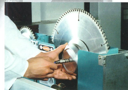
Schnellspannsystem für den Werkzeugwechsel.
