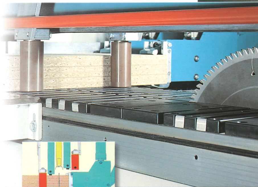
Auf Anfrage ist der Seitenausrichter mit 2 anhebbaren und unabhängig voneinander ansteuerbaren Rollen vor und hinter der Schnittlinie lieferbar.
