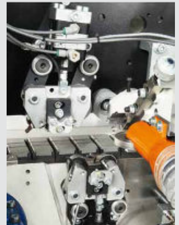
Flächenziehklingenaggregat „GS/K“ Beseitigung der Leimreste beim Plattenendbearbeitung
