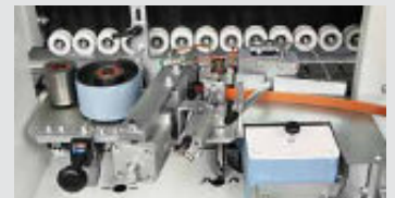
Anleimaggregat „GP 200“ 2 Andruckrollen und Kappschere für Kanten bis 3 mm Dicke
