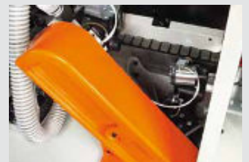
Kappaggregat „IK/200“ 2 Hochfrequenzmotoren, die sich von 0° - 15° einstellen lassen. Dadurch 2 Arbeitsmöglichkeiten möglich: Gerader Schnitt und Schrägschnitt
