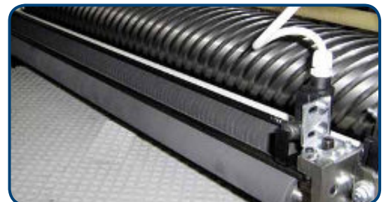
Erste Druckwalze mit Rücklaufsicherung (CE serienmäßig)
