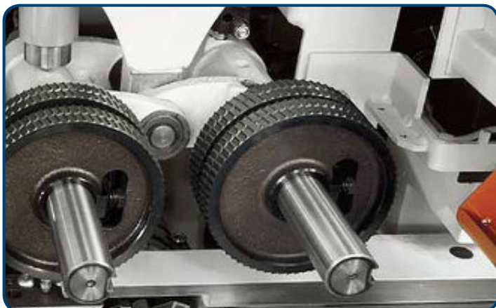
Doppel-Vorschubeinheit „Tandem“ vor der Universalspindel mit Schnellausschaltung des Vorschubs.
