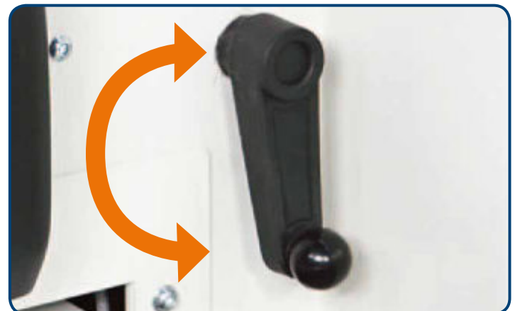
Leichte und schnelle Abschaltbedienung des Vorschubs für Notfälle
