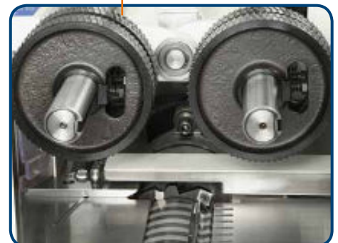
Abrichte - Fügefalzfräser Die erste Spindel ist mit einem Fügefalzfräser ausgestattet. Der Lärmpegel des Fräswerkzeuges wird durch die geschlitzten Tischlippen stark reduziert.
